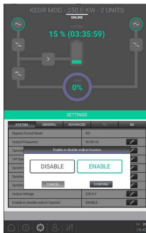
6. Selecionar a aba *BD* para configurar o número de KB (Kits de bateria) e a capacidade da bateria em Ah do KB individual. Tocar o ícone lápis do item *Número de Kit de baterias instaladas* e inserir o número de KB. Tocar o ícone lápis do item *Capacity value of Kit Batteries [Ah]* (Valor de capacidade do kit de baterias [Ah]) e insira o valor da capacidade da bateria.
