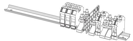
5. Remonter les bornes pour qu'elles adhèrent au séparateur fonctionnel isolant.
