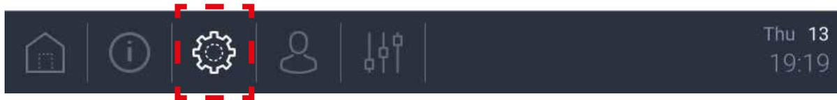
2. Tippen Sie auf „System“ und wählen Sie „OFF“, indem Sie auf das Bleistift-Symbol unter dem Punkt „Systemleistung“ tippen, um die USV auf OFF zu schalten.
