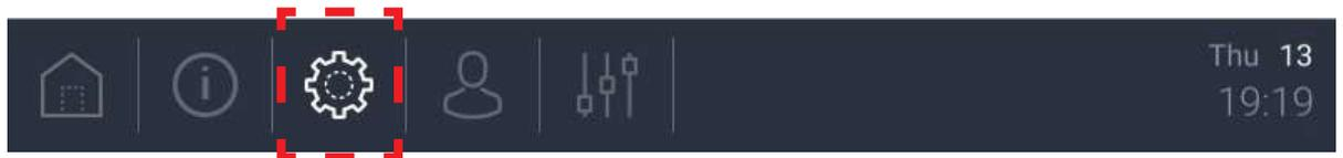
2. Sur l'onglet *Système*, assurez-vous que l'élément *By-pass actif* est réglé sur OUI. Si tel n'est pas le cas, appuyez sur l'élément et activez le by-pass.
