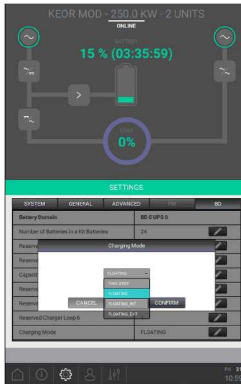
8. Régler la configuration des batteries (voir paragraphe 4.2.9) en touchant l'icône *Commandes générales* de la barre du menu au bas de l'écran.
