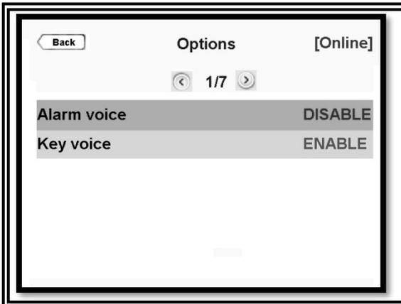
Die USV gibt eine akustische Warnung aus, wenn ein Alarm auftritt. Der Alarmton kann auf Wunsch deaktiviert werden. Von der USV kommt ein hörbares Geräusch, wenn die Tastatur verwendet wird. Das Tonsignal von der Tastatur kann auf Wunsch deaktiviert werden.
