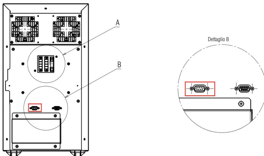
L'interfaccia a livelli logici è disponibile su connettore D89 posto sul retro dell'UPS e permette di collegare il gruppo di continuità ad un sistema remoto con lo scopo di monitorare il suo stato di funzionamento. Sono disponibili le seguenti segnalazioni e comandi:
