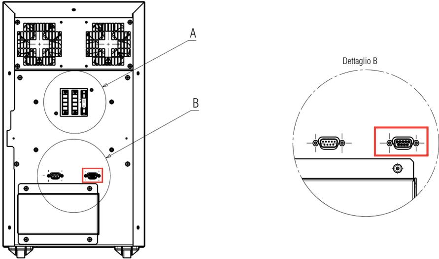
Grazie alla porta seriale RS232 è possibile accedere tramite un computer a una serie di dati relativi al funzionamento dell'UPS oltre a controllare lo spegnimento non presidiato del sistema operativo. La piedinatura dell'interfaccia è la seguente:
