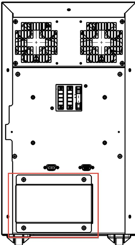
La scheda di rete SNMP è opzionale e permette di accedere a una serie di dati relativi al funzionamento del gruppo di continuità.
