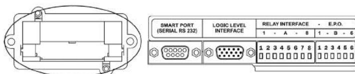
Sul retro dell'UPS Trimod HE è presente uno slot per scheda SNMP (opzionale). La corrente prelevata dallo slot SNMP per il funzionamento della scheda di rete deve essere complessivamente inferiore a 700mA.
