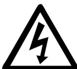
Según la norma EN 62040-1, el usuario debe colocar una etiqueta de advertencia sobre el panel de distribución de entrada y sobre los otros aisladores de potencia principales para evitar el riesgo de retorno de tensión.
