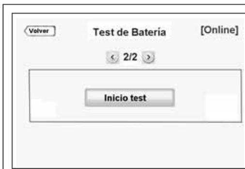
Con este comando se puede iniciar la función de prueba de la batería del SAI.
