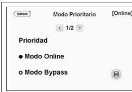
Por medio de este menú se puede escoger el modo de funcionamiento En línea o Bypass del SAI.
