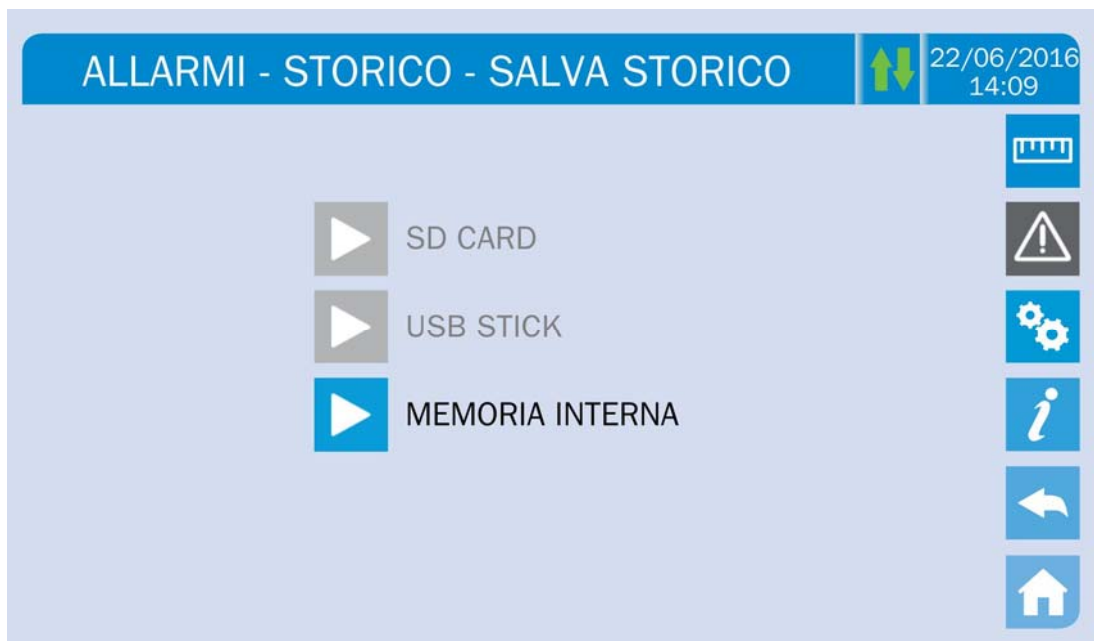
Figura 15 – Storico allarmi, salvataggio file
