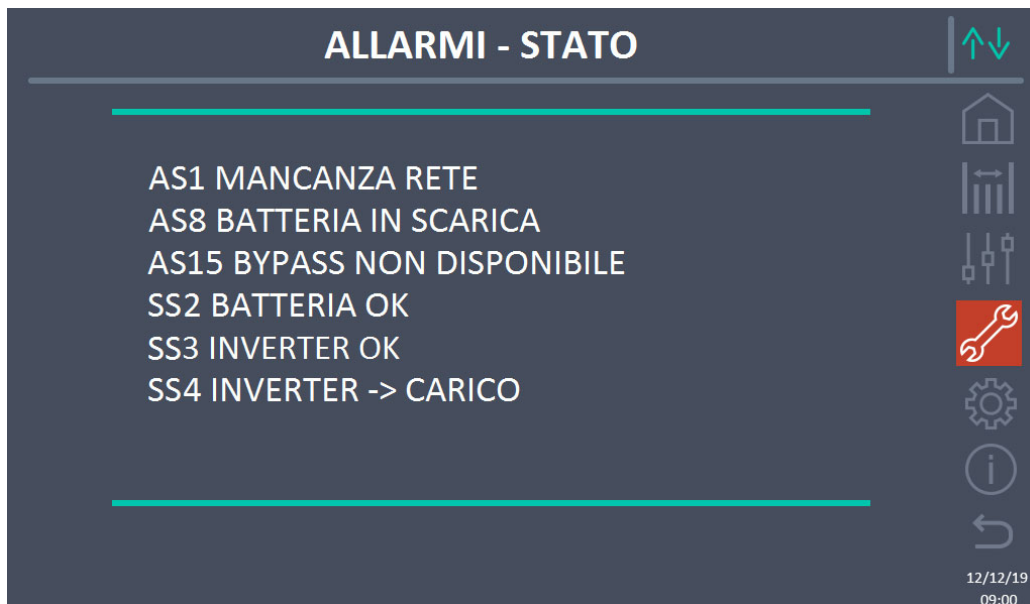
Figura 16 – Sezione ALLARMI - STATO (Sistema)
