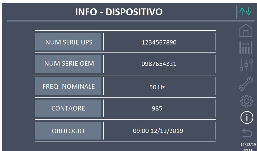
Figura 37 – Sezione INFO - DISPOSITIVO (Sistema)
