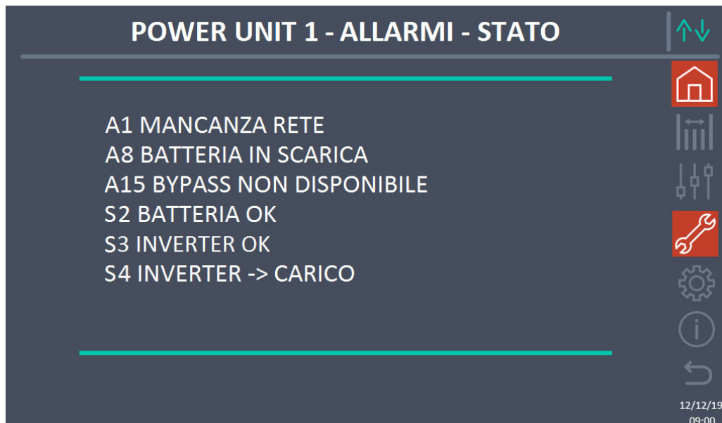
Figura 48 – Sezione ALLARMI - STATO (Power Unit)
